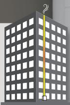
La caldera Xtreme HR se adapta a condiciones desafiantes en cualquier vivienda, gracias a que se pueden instalar **hasta 100 metros de chimenea de doble flujo**.
