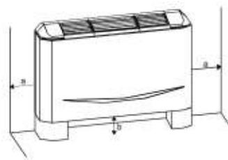
Unidad vertical con carcasa, con toma de aire inferior y salida por la parte superior de la carcasa, para su instalación en una pared o de pie sobre el suelo.
